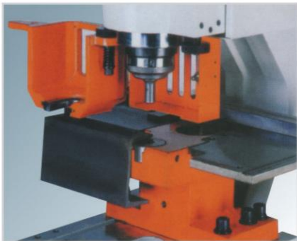
槽钢侧面冲孔模具
